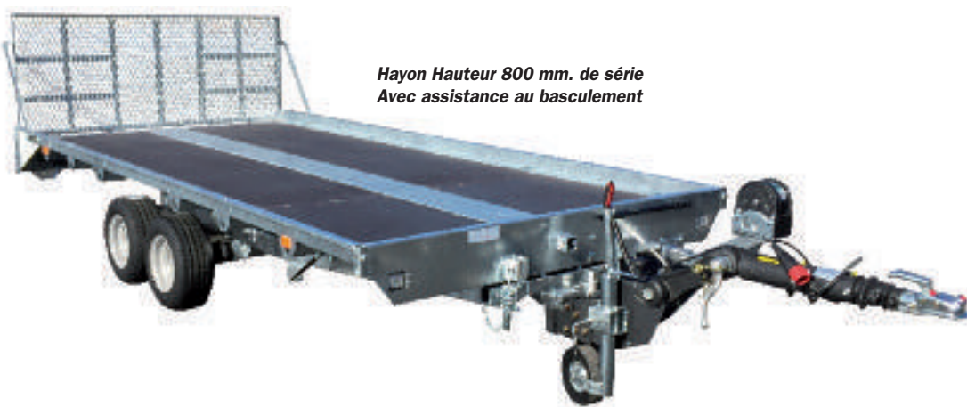
Basculement par 2 vérins à gaz renforcés
